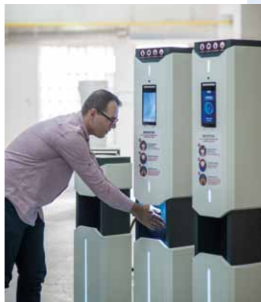
Уређај мери телесну температуру и дезинфикује руке
